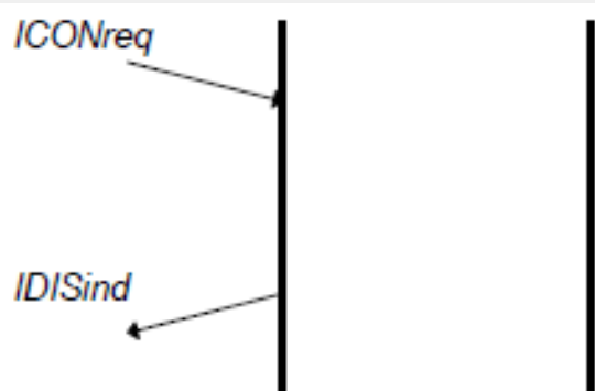
Rys 4 c) Nieudane nawiązanie połączenia (Błędna transmisja żądania nawiązania połączenia)
